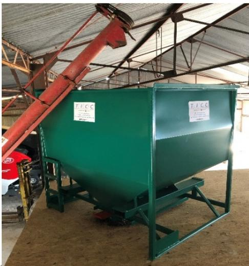
Trémie positionnée à l'étage au dessus du moulin par chariot élévateur ou transpalette manuel
