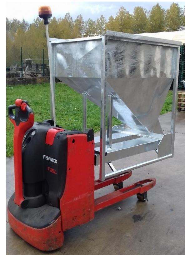
Largeur égale à celle d'un transpalette/gerbeur pour faciliter l'accès aux bacs à sel inaccessibles par chariot élévateur.
