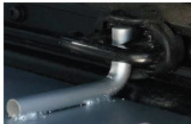
Plateforme sécurisée par des systèmes de verrouillage avec fixation sur les accroches rapides de la benne
