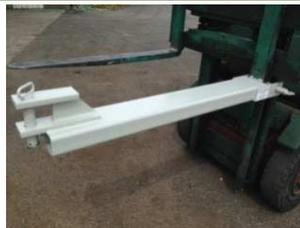
Fourche attelage. Permettant le déplacement au sol de remorques, épandeurs ou tout autre matériel roulant sans avoir d'engin de traction disponible sur place. Largeur intérieure 148 mm.
